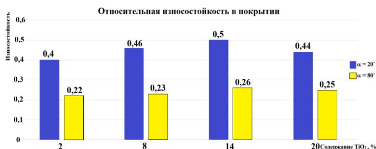
Рисунок 2 – Диаграмма относительной износостойкости плазменных покрытий из смеси оксидов алюминия и титана
