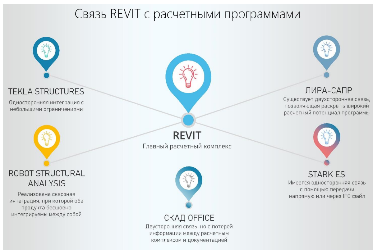
Рисунок 1 – Связь Revit с расчетными программами
