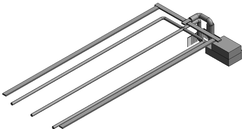
Рисунок 3 – Конфигурация системы кондиционирования с текстильными воздуховодами
