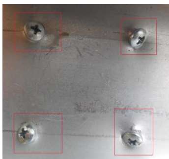
Рисунок 3 – Смятие металла в зоне саморезов
